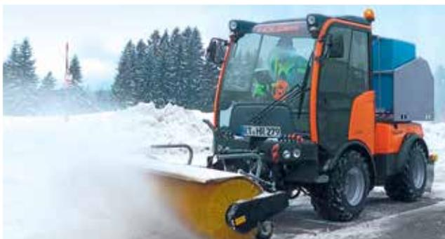
C 370 mit Kkehrbürste (170 cm) und Sole-Anlage (0,65 m<sup>3</sup>)
